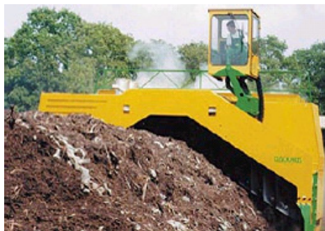
Utilaj special pentru umezire și întoarcere a compostului
